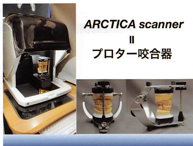
図5 CADスキャナに装着された専用ジグ
