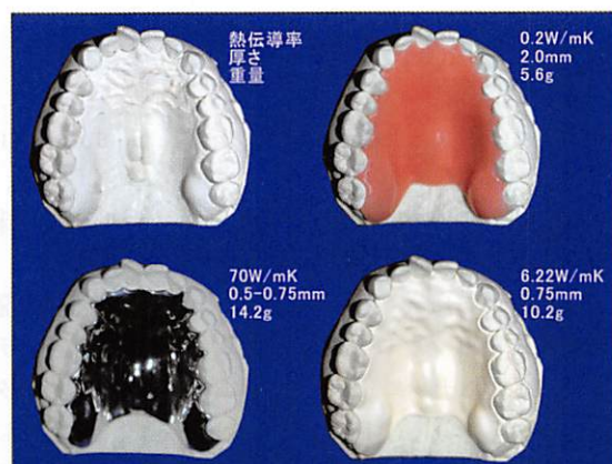
写真7 実験に用いた3種類の口蓋被覆材料による試料
