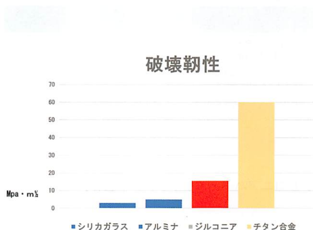
図8 ジルコニアの破壊靱性比較表 山本金属 ジルコニアの基礎知識と製品レポートより
