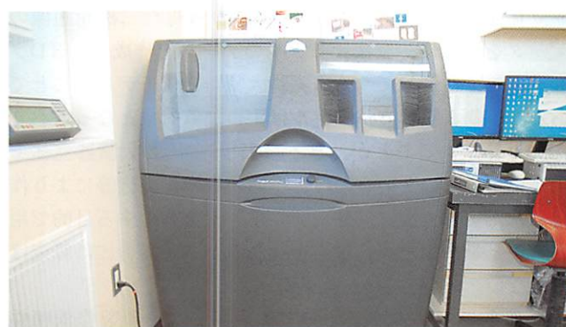
図3 石膏プリンター ProJet 460plus (3D Systems)
