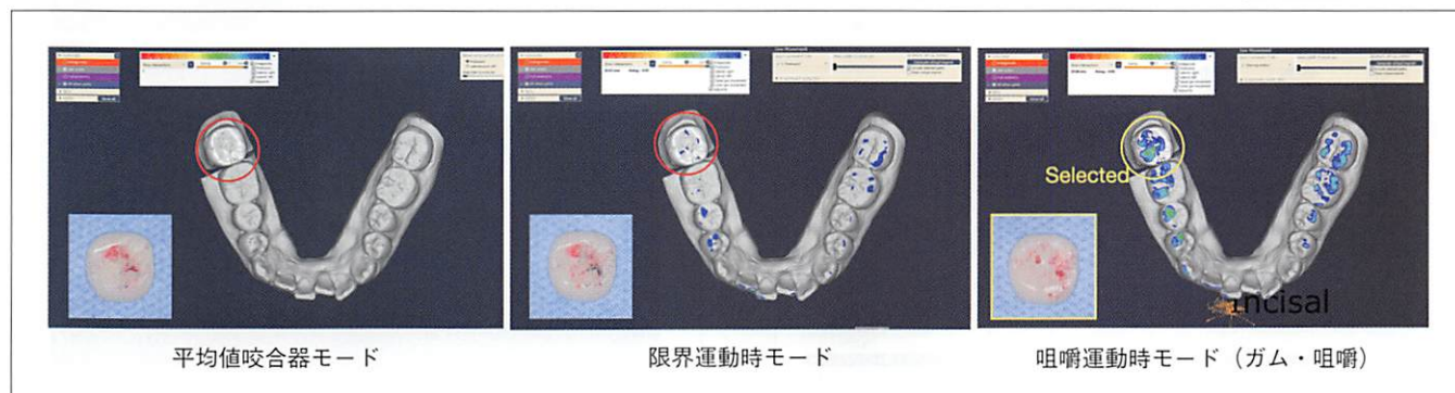
図9 〈症例3〉 バーチャル咬合器上で各種顎運動を測定し製作したオールセラミッククラウン
