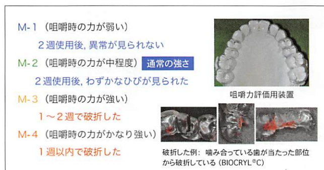
図8 咀嚼力評価用装置による咀嚼力の評価方法と評価基準 装置が劣化して破折するまでの時間で評価する。
