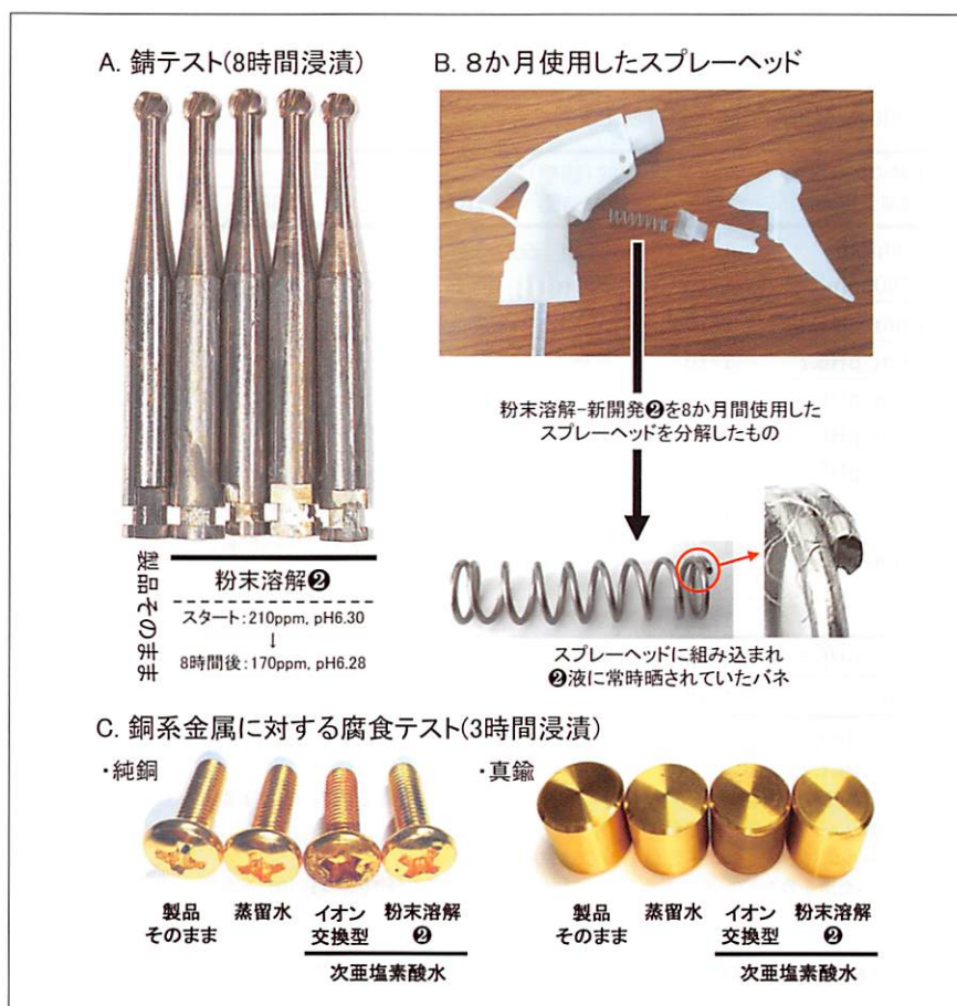
図5 粉末溶解②を用いた錆・腐食発生テストとその実際
