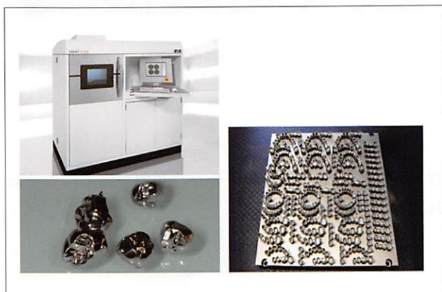
図12 金属粉末積層造形機器と、製作したコバルトクロム金属冠 一度に400 ユニット製作可能。
